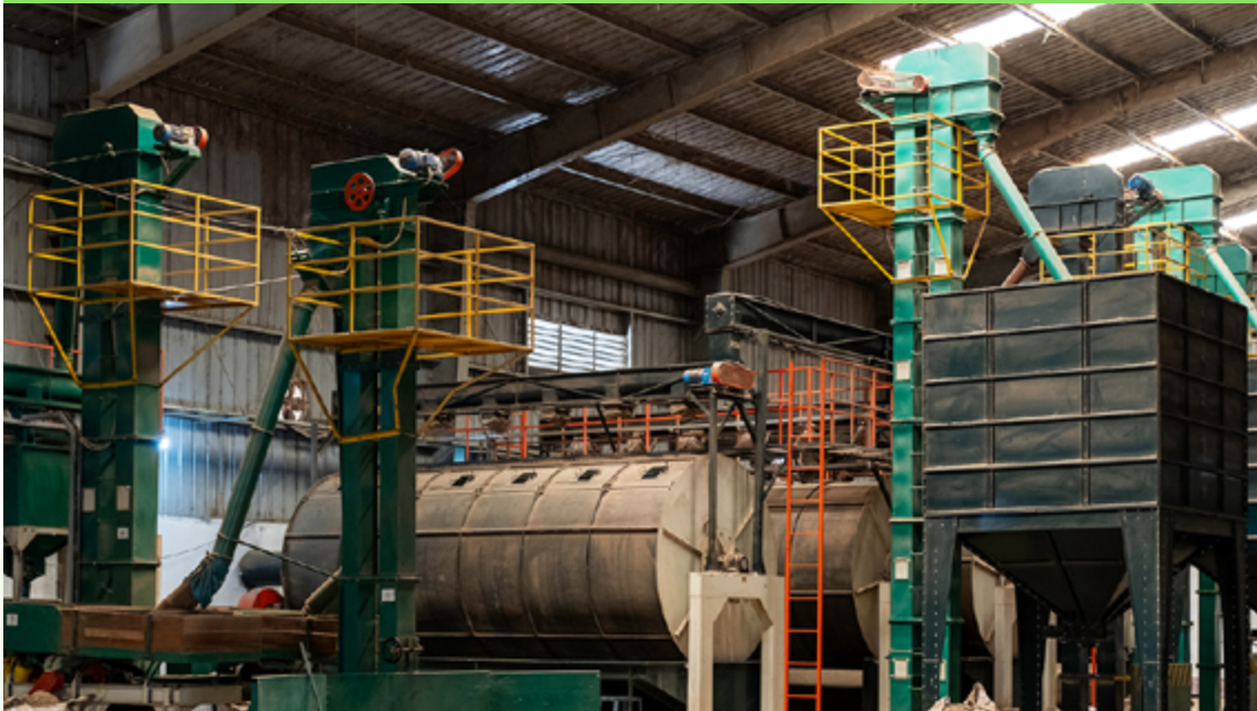
► Ilustración 36. Barandillas instaladas en plataformas para evitar la caída de trabajadores.
